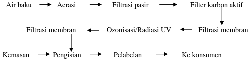
Gambar 1. Skema proses pengolahan air minum
